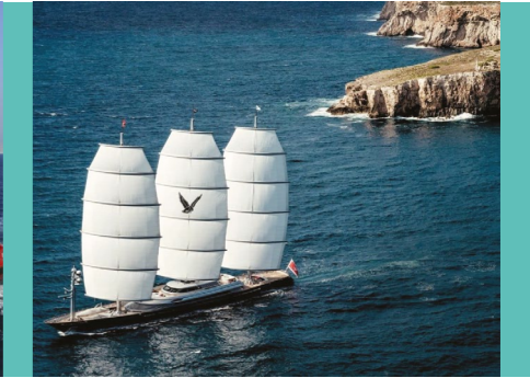
Dynarig Sisteminin İlk Büyük Boyutlu Uygulaması
